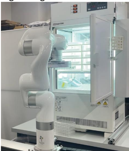
人工気象機からのプレート取出しシステム
