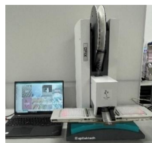
図 16 タンパク質結晶化用ナノリッター分注機 mosquito Xtal3（SPT Labtech 社製）を用いた結晶化スクリーニング
