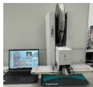
図 8 タンパク質結晶化用ナノリッター分注機 mosquito (SPT Labtech 社製)を用いた結晶化スクリーニング
